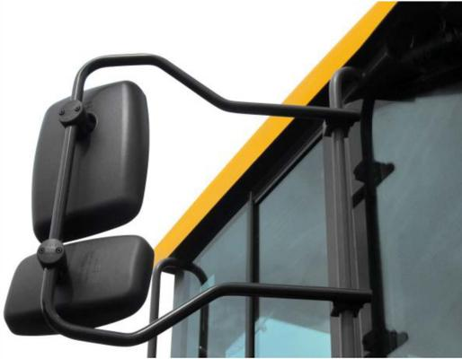
**Gli specchietti retrovisori** sono assolutamente fondamentali per lavorare in sicurezza. Gli specchietti Volvo sono regolabili elettricamente per un **perfetto posizionamento e visibilità**. Inoltre sono riscaldati, contro nebbia e ghiaccio. Tutto ciò per la **sicurezza ed il comfort** dell'operatore.
