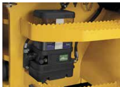
Impianto di lubrificazione centralizzata
